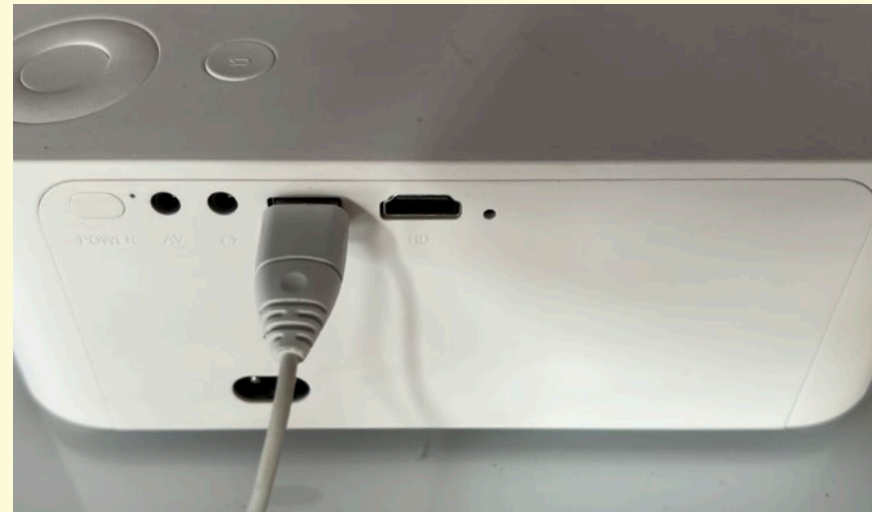
Conectarem els altaveus al videoprojector a través del conector USB
